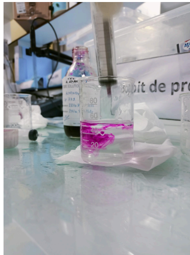
Figure 37 : Mélange des solutions et ajout du KMnO 4 à la solution.
