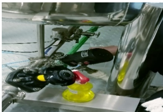
Figure 27 : Désinfection la vanne par l'alcool.
