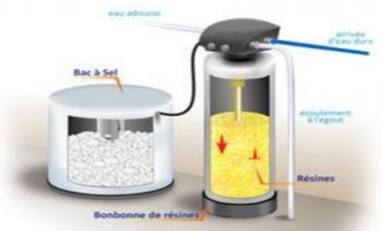
Figure 07 : Fonctionnement d'un adoucisseur d'eau[34].
