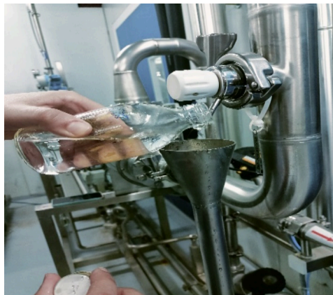
Figure 28 : Purger la vanne pour éliminer l'eau stagnants.
